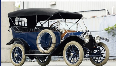
▲ Cadillac Model 30 Self Starter, первый серийный автомобиль с электрическим стартером, зажиганием и светом
